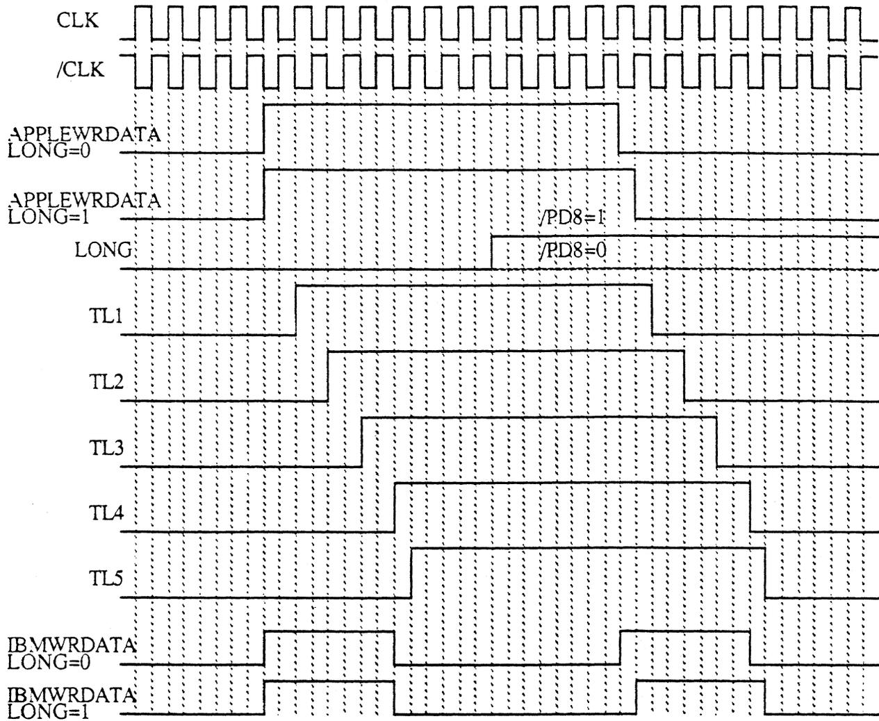
$$WRDATA = \overline{TL4} * WRDATA * \overline{LONG} + TL4 * \overline{WRDATA} * \overline{LONG} + \overline{TL5} * WRDATA * LONG + TL5 * \overline{WRDATA} * LONG$$
