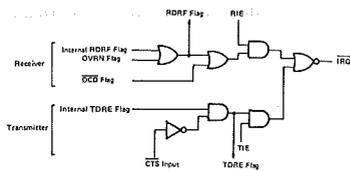
Fig. 14  $\overline{IRQ}$  Internal Circuit
