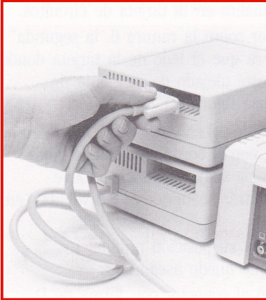
Figura 8. Cómo instalar una segunda UniDisk
