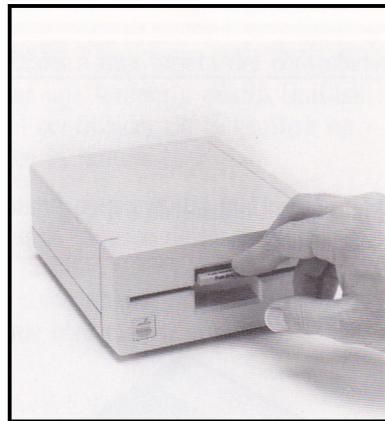
Figura 13. Cómo cerrar la puerta de inserción del disco
