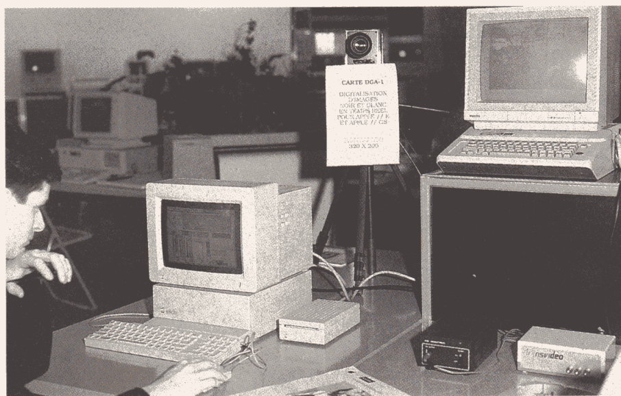
La carte DGA-1 permet de digitaliser une image sur l'ordinateur Apple IIGS.
