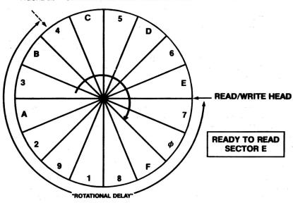
FIGURE 3.6 — STANDARD DISKETTE POSITION AFTER ROTATIONAL DELAY
